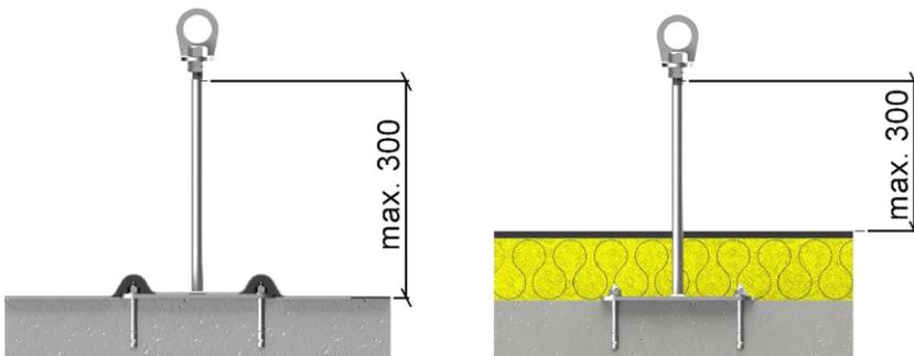
Der Untergrund muss Teil der statischen Grundkonstruktion sein.
