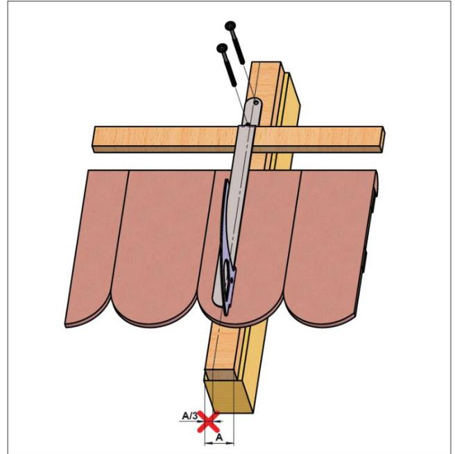
Richten Sie den Dachhaken so aus, dass die geeigneten 2 Stk. Befestigungsschrauben in der Mitte des Sparren befestigt werden können.
