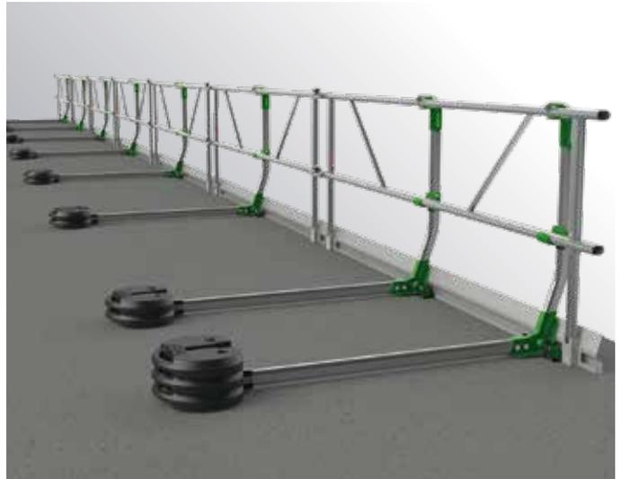
Die AluFix® EVO-Absturzsicherung ist ein freistehendes temporäres Schutzgeländer mit Gegengewichten für sicheres Arbeiten auf Ebenen bis 10° Neigung. Es erfüllt die Anforderungen der Norm EN 13374-A.
