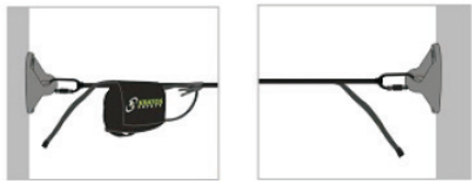
Caso 1: Existem pontos de fixação (EN 795 Tipo A)
