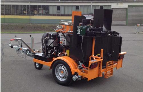
Geräte zum Aufschmelzen und Verarbeiten von bituminösem Fugen- und Schienenvergussmaterial.
