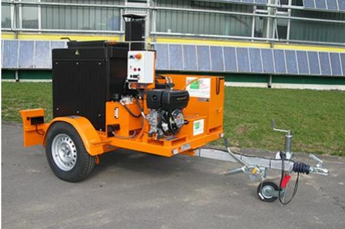
Geräte zum Aufschmelzen und Verarbeiten von thermoplastischen Fahrbahnmarkierungsmassen und bituminösen Fugen- und Schienenverguss- sowie Schienenuntergussmaterialien
