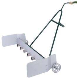
Zur vollflächigen Verklebung von Bitumen-Schweißbahnen. Die gesamte Breite der Dichtungsbahn wird gleichmäßig aufgeschmolzen. Der Brenner kann über die großen Laufrollen abgekippt werden, so dass die Schweißstellung variabel ist. Flammenbecherdurchmesser 45 mm.
