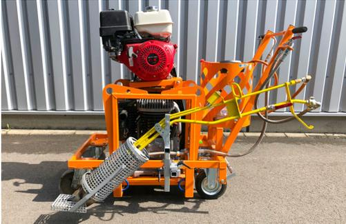
Zum Trocknen, Anschmelzen und Ausblasen von Rissen und Fugen in Straßenbelägen. Zur Schaffung idealer Voraussetzungen für den Heißverguss.
