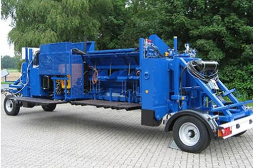
für den maschinellen Einbau von Gussasphalt im Straßenbau mit maschineller Absplittung
