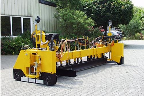
für den maschinellen Einbau von Gussasphalt im Gleis-, Straßen- und Hallenbau
