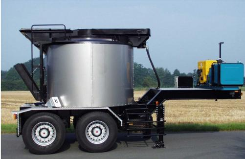
Spezielle Geräte für den Transport von Gussasphalt und Mastix.
