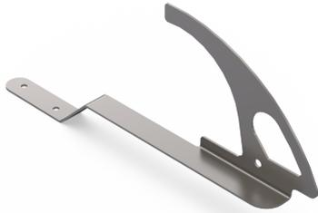
Sicherheitsdachhaken aus Edelstahl für geneigte Dächer, zum Einhängen von Dachdeckerleitern, zum Befestigen von Dachdeckerstühlen und als Anschlagereinrichtung für PSaGA.
