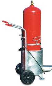
Die feuerverzinkte Ausführung, macht Schluss mit Flaschenvereisungen und garantiert volle Arbeitsleistung und restlose Gasausnutzung. Die Gasflasche wird in einem temperaturüberwachten Wasserbad erwärmt, und der Dampfdruck wird auf ca. 10 bar erhöht, wodurch Arbeitsdruck und Gasmenge selbst bei extremen Entnahmen sichergestellt werden. Thermostatisch regulierter Elektro-Heizstab 220 V. Angewärmt werden können sowohl 1 Gasflasche 33 oder 11 kg. Der Flaschenträger ist im Lieferumfang enthalten.
