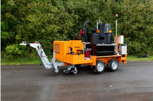
Kesselinhalt mit vertikalem Rührwerk und Selbstfahrantrieb.
