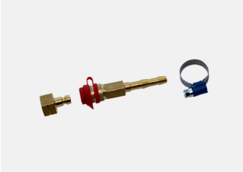
Das problemlose Stecksystem ermöglicht einen schnellen Wechsel der Brenner ohne Schließen der Gasflasche, da die Kupplung am Schlauch beim Auskuppeln gasdicht schließt. Kein Aufwickeln der Propanschlauches.
