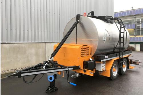
Zum Transportieren von Voranstrich, Bitumenemulsionen und polymermodifizierten Bindemittel.
