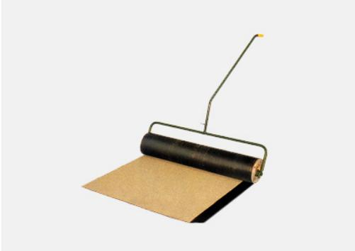
Mit kugelgelagerter Walze ermöglicht eine exakte Führung der Dichtungsbahnen bei der Verlegung und gibt die Sicht auf die Schweißbraupe frei. Durch das Eigengewicht der Walze wird die Bahn gleichmäßig angedrückt.
