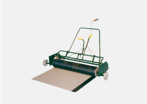
Zur vollflächigen und streifenweisen Verklebung von Bitumen-Schweißbahnen. Die gleichmäßige Beaufschlagung der Dichtungsbahn mit kurzer, kontrollierter Flamme und die Fixierung des Schweißabstandes bis zum Rollenende garantieren eine einwandfreie Klebequalität sowie hohe Verlegeleistung bei niedrigem Gasverbrauch. Der Schweißbrenner ist herausnehmbar und als Sologerät einsetzbar. Die kugelgelagerte Walze garantiert den erforderlichen Anpressdruck.
