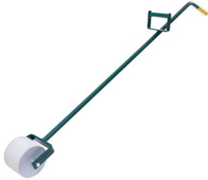
Zum Anpressen der Überlappungen beim Nahtverschweißen. Der Silikon-Schutzmantel verhindert Bitumenverschmutzungen der Rolle. Andrückbreite ca. 80 mm, Gesamtlänge ca. 1.150 mm.
