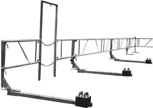
Temporäres Schutzgeländer aus stabilen Aluminiumprofilen mit einem max. Stützenabstand von 5,8 m, für Dachflächen bis 10° Neigung bzw. mit Zubehörteilen auch für Satteldächer bis 18°
