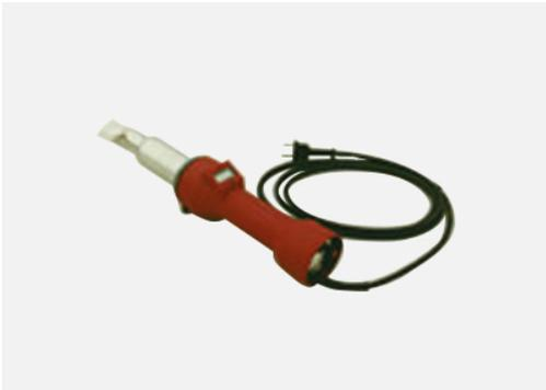
Zur Nahtverschweißung von Kunststoff- und bituminösen Dichtungsbahnen, zum Verformen und Verschweißen von thermoplastischen Kunststoffen, zum Anwärmen und Auftauen. Das Schweißgerät Airtronic ist vollelektronisch gesteuert, hat 230 V, 50 Hz, die Temperatureinstellung liegt bei ca. 50 – 700 Grad, es hat eine stufenlose Gebläseeinstellung und besitzt eine Nachlaufkühlung.
