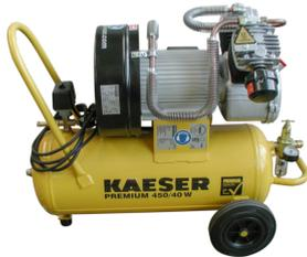
Dieser 2-Zylinder-Kolbenkompressor mit Wartungseinheit 1/4" ermöglicht ein unterbrechungsfreies Arbeiten mit den Druckluft-Werkzeugen. Es ist stets ein Nebelöler zu verwenden.
