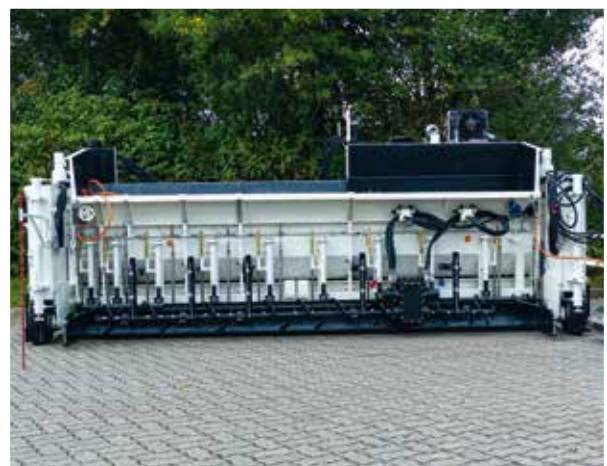
■ Gussasphalt-Einbaubohle KBR 75 SSL u. a. mit Schwertverteiler
